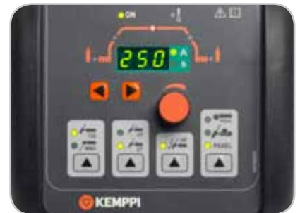
Panel sterowania maszyny MasterTig LT 250: wybór procesu (TIG lub MMA), zajarzenie łuku HF lub TouchArc, tryb pracy uchwytu (2T lub 4T) i wybór zdalnego sterowania. Wyświetlanie wartości prądu, zadawanie czasu przed- i po-gazu, programator narastania/opadania prądu.
