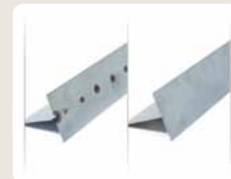
Różnica w jakości spoin szepczych jest wyraźnie widoczna. Spoinę z lewej strony wykonano z wykorzystaniem funkcji MicroTack, zaś spoinę z prawej - standardową metodą TIG.
