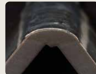
Stabilny łuk oznacza gładką spoinę i silne połączenie z materiałem spawanym, co przekłada się na dobre własności mechaniczne spoiny.
