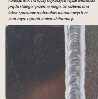
Stabilny łuk oznacza gładką spoinę i silne połączenie z materiałem spawanym, co przekłada się na dobre własności mechaniczne spoiny.
